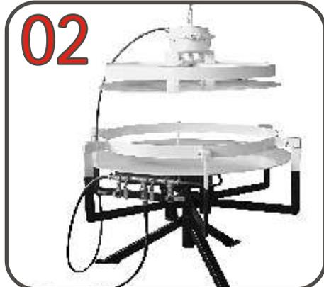
Composto por dois flanges de vedação, acionados através do sistema de ar comprimido.
