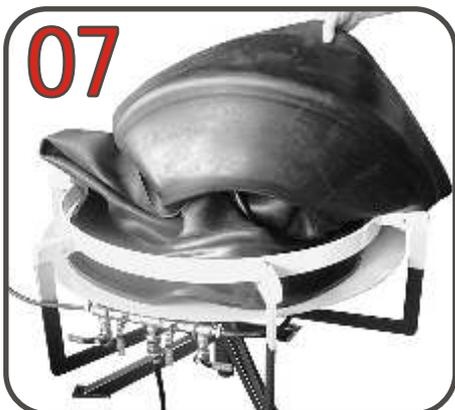
Posicione o envelope sobre a mesa conforme imagem 07, prendendo o flange de vedação na base inferior do equipamento.
